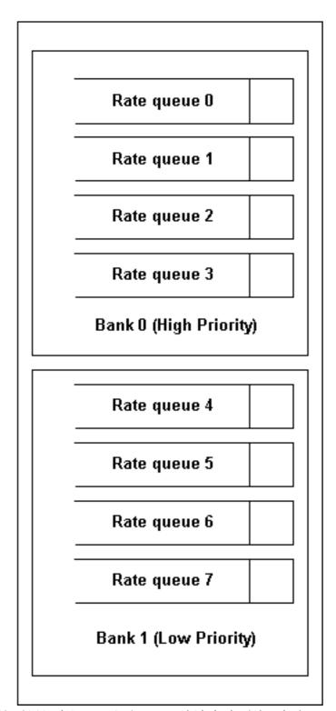
链接到低优先级组(银行1)中的速率队列的数据包无法传输,而高优先级组(银行0)中的速率队 列不为空。
