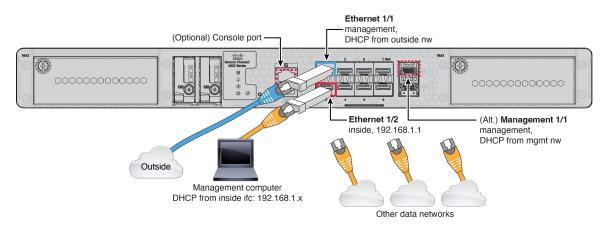
Management 1/1 またはイーサネット 1/2 のいずれかで Cisco Secure Firewall 4200 を管理します。 デフォルト設定でも、Ethernet1/1 を外部として設定します。
