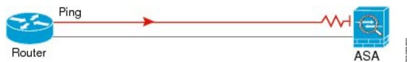
図 68: ASA の戻りルート未設定による ping の失敗
