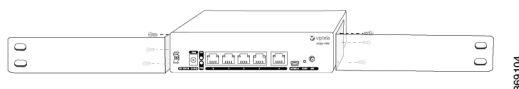
図 27: vEdge 100b ルータシャーシへの固定用 L 字金具の取り付け
