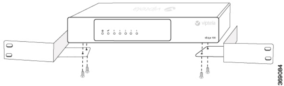
図 7: vEdge 100 ルータシャーシへの固定用 L 字金具の取り付け
