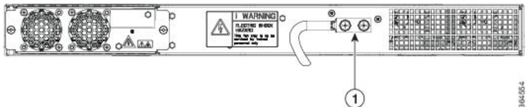
図 19: ルータの背面へのアース ラグの取り付け
