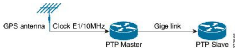
図 8: GPS デバイスをプライマリ基準とする通常クロックシナリオ
