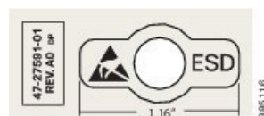
図 2: Cisco ASR 9910 ルータシャーシの静電気防止用ラベル情報
