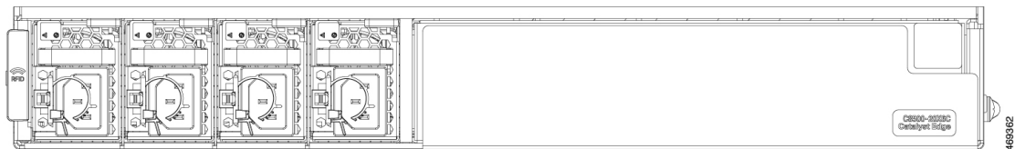
Figura 11: Vista frontal de Cisco C8500-20X6C: fuentes de alimentación
