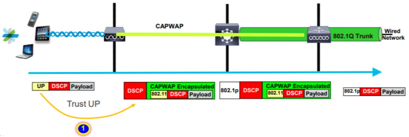
2 - AP將原始資料包封裝到CAPWAP報頭中，並將UP對映到外部DSCP值，只要WLC上配置的QoS配置檔案允許該QoS級別。將資料包傳送到具有原始DSCP值的有線網路。
