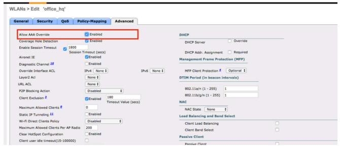
3. 您還必須在WLC上為使用者VLAN建立動態介面。導航到Controller > Interfaces UI選單。如果WLC在該VLAN中具有動態介面,則它只能支援透過AAA接收的VLAN分配。
