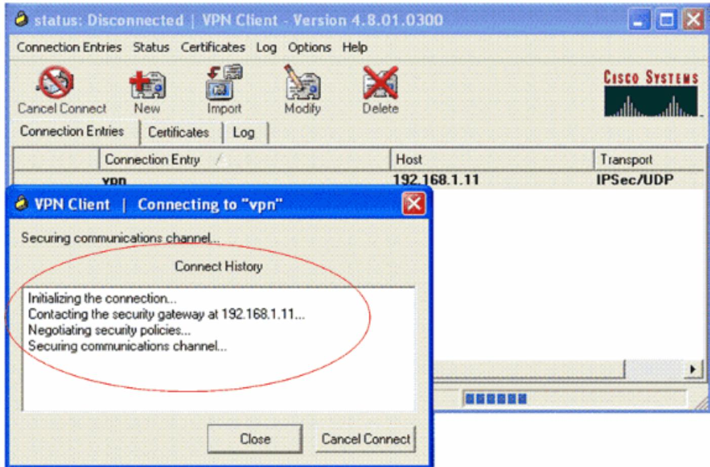
**注意：**為了建立此VPN隧道，VPN客戶端和伺服器之間應具有IP可達性。如果VPN客戶端無法與安全網關（VPN伺服器）聯絡，則隧道未建立，客戶端將顯示一個警報框，並顯示以下消息：
