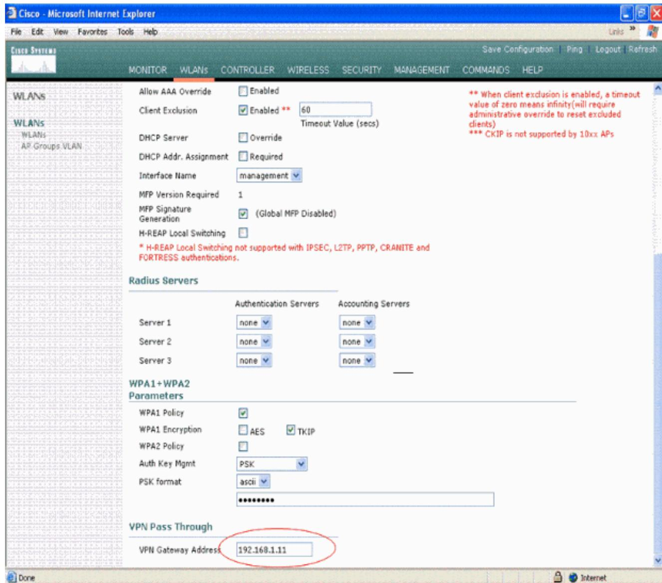
8. 按一下「Apply」。現在將名為`vpnclient`的WLAN配置為VPN傳輸。
