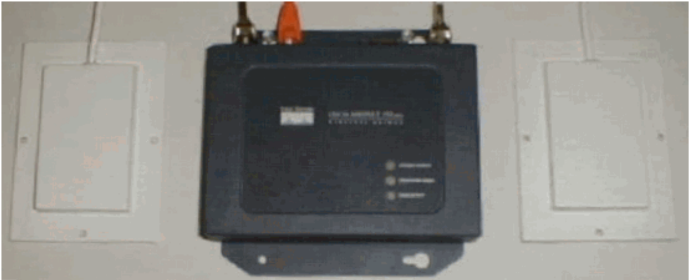
圖4 — 帶有兩個6.0 dBi分集天線的Cisco Aironet 350系列無線裝置
