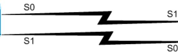
路由器Montecito和Goleta通過介面Serial0和Serial1進行背對背連線。此配置在每個端使用虛擬模板、多鏈路點對點協定(PPP)，並在路由器之間橋接並路由IP和IPX。
