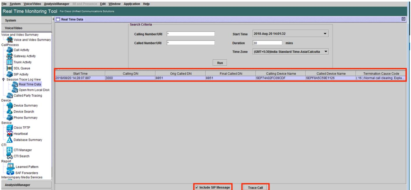
步驟5.您可以在呼叫流程圖部分下檢視整個呼叫流程，並點選檢視與任何特定SIP消息相關的日誌。
