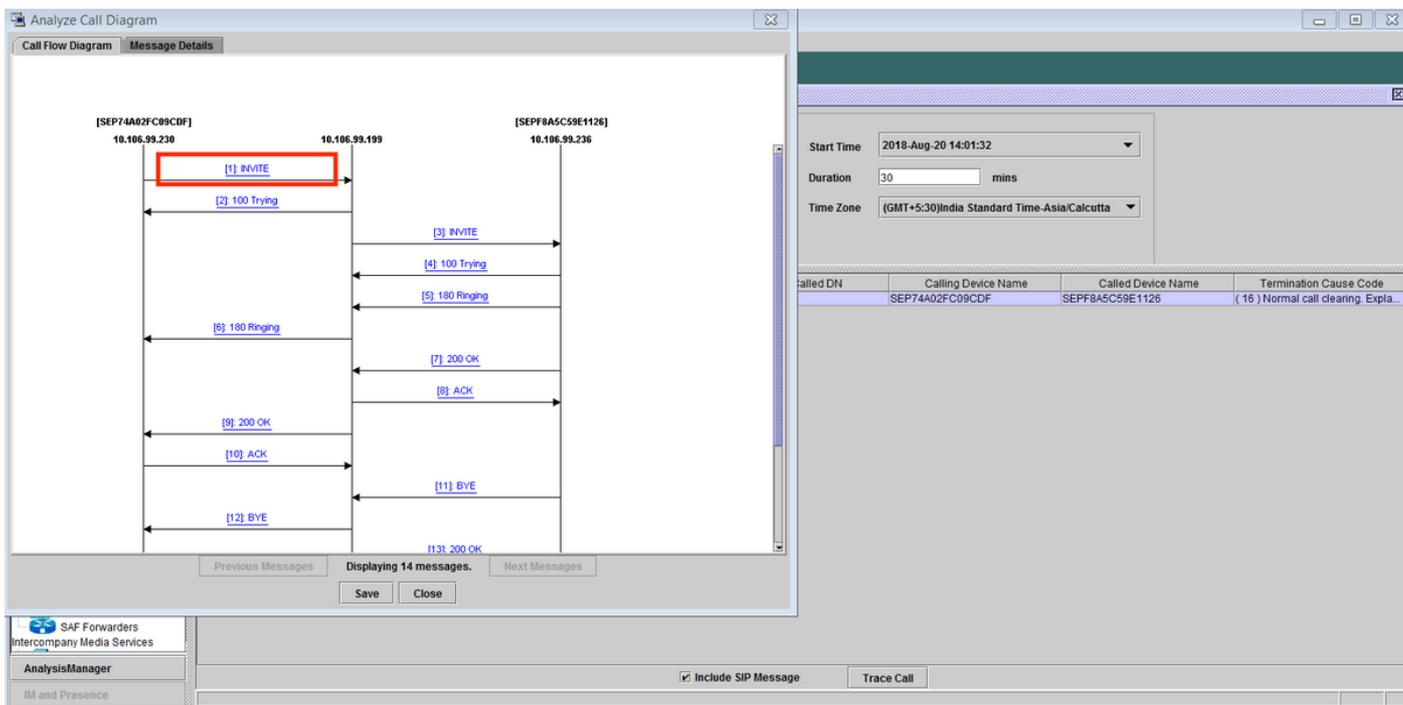
步驟6. 特定消息的詳細信令顯示在消息詳細資訊部分下，要導航回呼叫流程，請按一下呼叫流程圖。若要儲存特定通話的SIP記錄，請按一下Save，如下圖所示。
