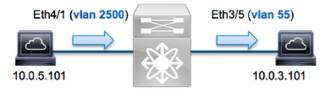
在本範例中，VLAN 2500(10.0.5.101)上連線埠Eth4/1上的主機向VLAN 55(10.0.3.101)上連線埠Eth3/5上的主機傳送網際網路控制訊息通訊協定(ICMP)請求。ELAM是用來擷取從10.0.5.101到10.0.3.101。請記住AM允許您捕獲單個幀。
