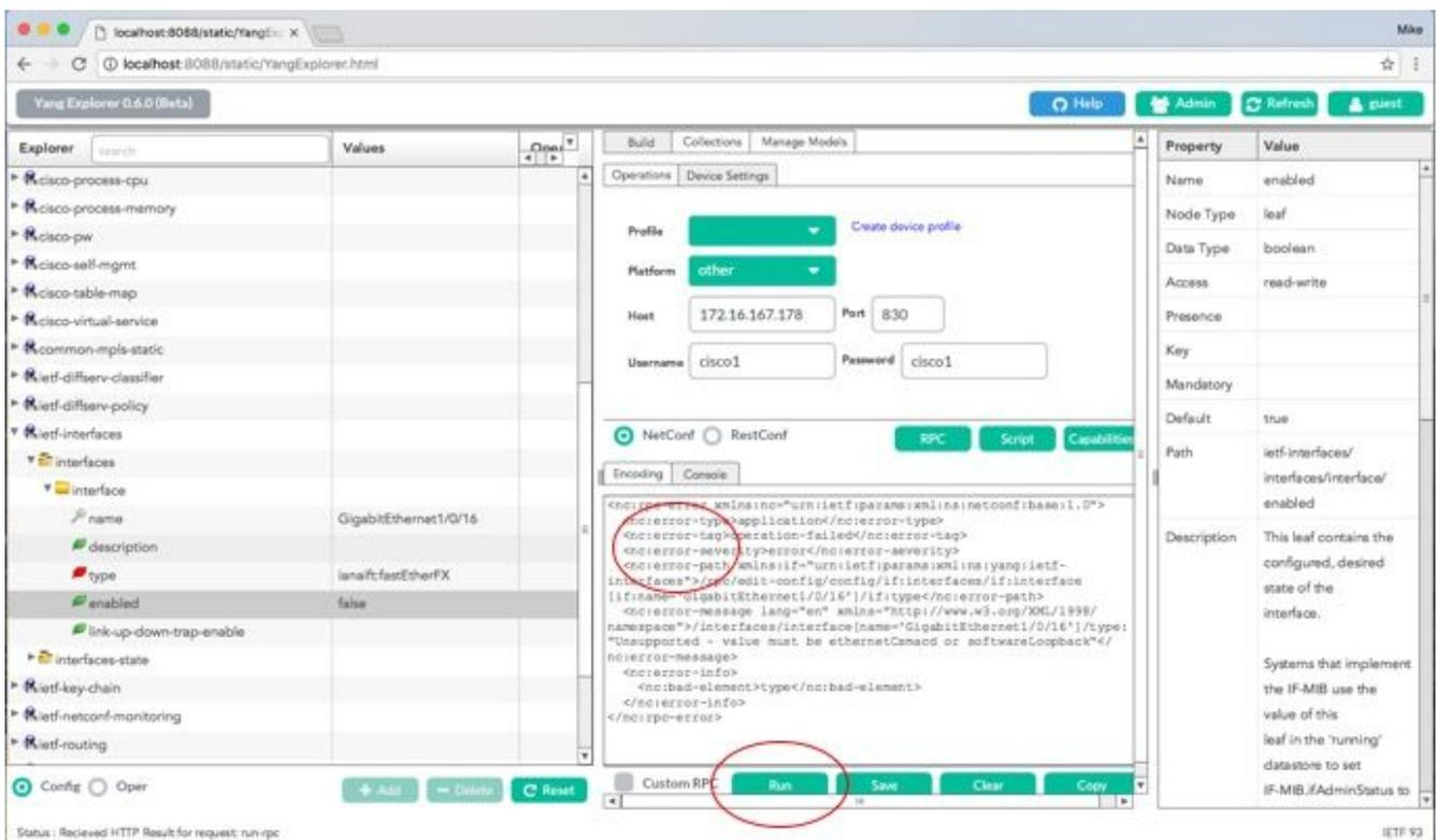
以下是Catalyst 3850傳回的錯誤。請注意，它包含錯誤標籤「operation-failed」，並包含與錯誤相關的更多詳細資訊，如「Unsupported - value must be ethernetCsmacd or softwareLoopback」</nc: error-message>。
