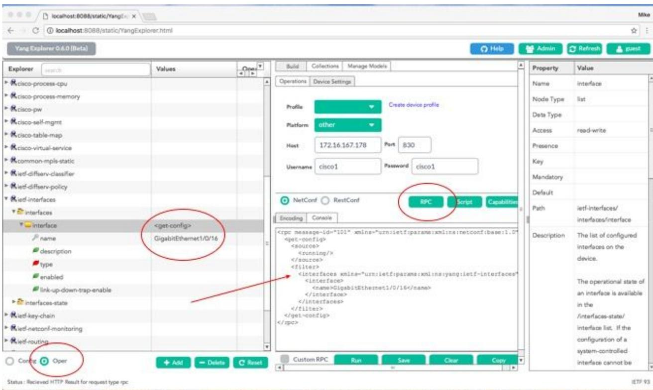
選擇Run以將RPC消息傳送到Catalyst 3850後，Catalyst 3850會使用YANG格式的介面配置進行回覆，該配置顯示介面型別為iana: ethernetCsmacd。
