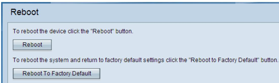
步驟2. 按一下「**Reboot To Factory Default**」，重新啟動存取點，並將裝置回覆為出廠預設設定。重新引導至出廠預設設定後，所有儲存的配置都將丟失。
