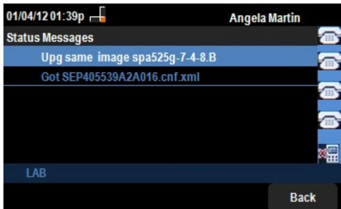
由於SPA525G/SPA525G2上目前沒有活動，它顯示啟動後執行的第一個活動；從統一通訊裝置獲取韌體。「Got SEP405539A2A016.cnf.xml」是從統一通訊裝置獲得的檔案。當需要執行任何故障排除時，這些消息可以作為調試跟蹤提供幫助。
