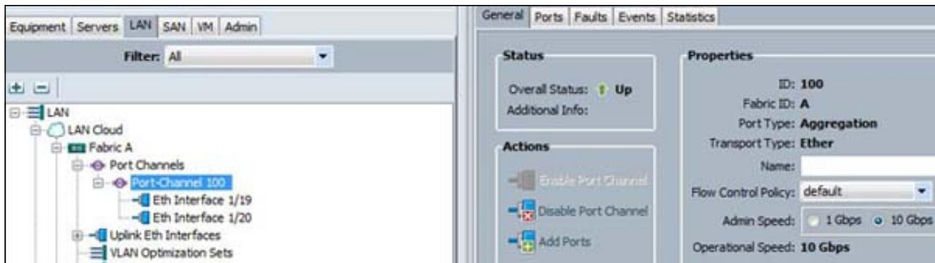
如果上游交換機配置正確，則整體狀態將變為Up狀態。
