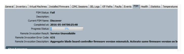
可通過命令列(CLI)檢查不匹配的韌體,如下所示。在下面的輸出中,第一個主機板控制器是主控制器,第二個是從控制器。
