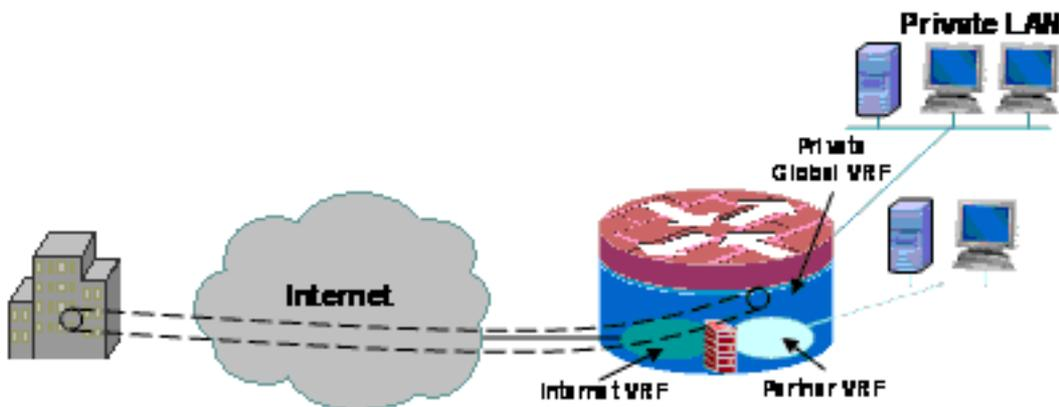
本示例描述兩個寬頻網際網路連線的配置，將PAT（NAT過載）應用於公共中的主機和合作夥伴VRF以訪問公共Internet，同時通過兩個連線上的SLA監控來保證網際網路連線。專用網路（在全域性VRF中）使用GRE-over-IPsec連線通過兩條寬頻鏈路保持與HQ的連線（VPN前端路由器包含配置）。當寬頻連線中的其中一個出現故障時，保持與VPN頭端的連線，這樣便允許不間斷地訪問HQ網路，因為隧道的本地端點不是專門與其中一個Internet連線相連。
