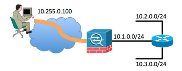
在本示例中,為遠端訪問客戶端分配了IP地址10.255.0.100。本示例中的ASA與路由器一起連線到同一個內部網段。路由器有兩個附加的第3層網段與其相連。示例中顯示了ASA和路由器的相關介面(路由)和VPN配置。
