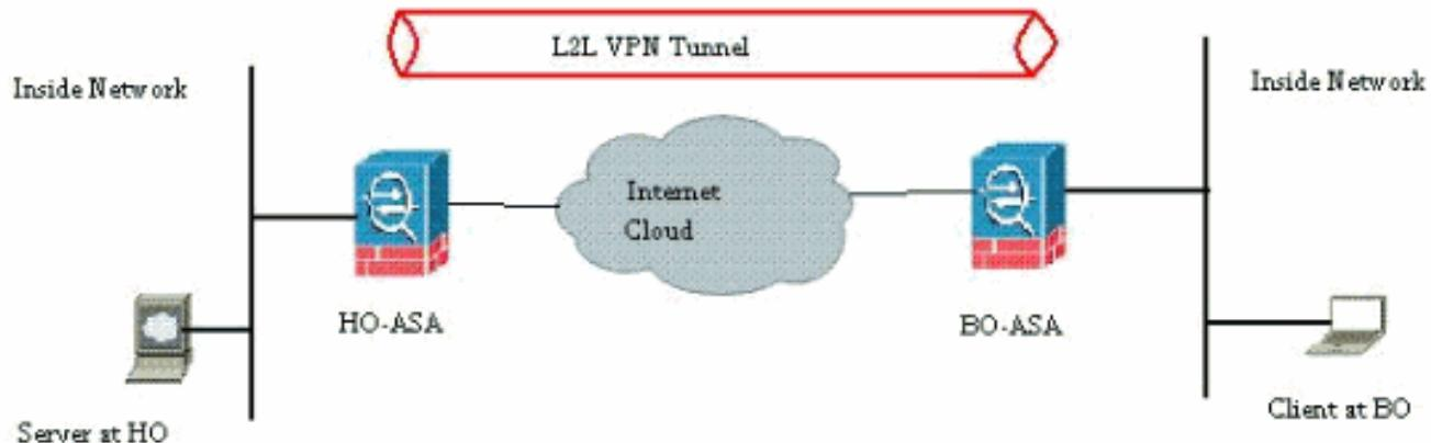
之所以會出現此問題，是因為ASA工作方式的內建功能。ASA監控通過它的每個連線，並根據應用檢查功能在其狀態表中維護一個條目。通過VPN的加密流量詳細資訊以安全關聯(SA)資料庫的形式維護。對於本文檔的情況，它維護兩個不同的流量。一個是VPN網關之間的加密流量，另一個是總部伺服器和分支機構終端使用者之間的流量。當VPN終止時，此特定SA的流詳細資訊將被刪除。但是，ASA為此TCP連線維護的狀態表項因沒有活動而失效，從而阻礙了下載。這意味著在使用者應用程式終止時，ASA仍會保留該特定流的TCP連線。但是，在TCP空閒計時器過期後，TCP連線將丟失，並最終超時。
