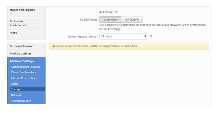
更改「AV定義」策略設定後,新設定將在下次計畫病毒定義更新時生效。該延遲由「內容更新內部」策略設定控制。
