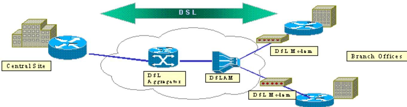
Cisco 2600和3600路由器支援ADSL WAN介面卡(WIC-1ADSL)。此WIC-1ADSL是一種多服務和遠端訪問解決方案，旨在滿足分支機構的需求。WIC-1ADSL和硬體加密模組的引入滿足了分支機構對單一路由器解決方案中IPSec和DSL的需求。WIC-1ADSL無需使用單獨的DSL數據機。當硬體加密模組從路由器解除安裝處理加密時，與純軟體加密相比，該模組可提供高達10倍的效能。
