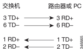
图 9: 两对双绞交叉电缆图解
