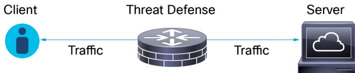
客户端确立与服务器的 TCP 连接后（成功完成 TCP 三向握手后），托管设备会监控 TCP 会话的任何启动加密会话的尝试。TLS/SSL 握手通过使用交换客户端与服务器之间的专门数据包来确立加密会话。在 SSL 和 TLS 协议中，这些专门数据包称为握手消息。握手消息传达客户端和服务器都支持的加密属性：
