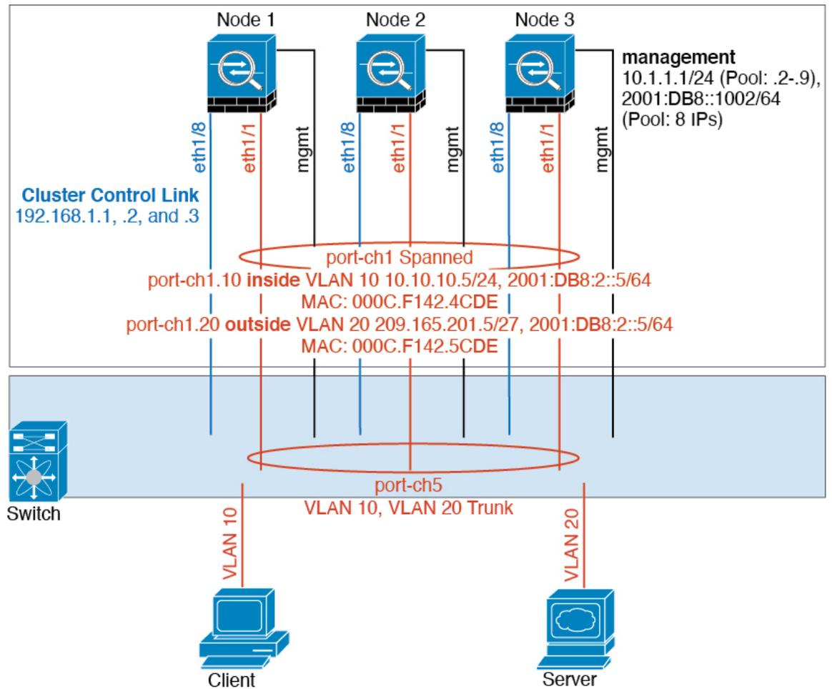
来自不同安全域的数据流量与不同的 VLAN 关联，例如，VLAN 10 用于内部网络，而 VLAN 20 用于外部网络。每台 ASA 都有一个连接到外部交换机或路由器的物理端口。启用中继使物理链路上的所有数据包都采用 802.1q 封装。ASA 是 VLAN 10 与 VLAN 20 之间的防火墙。
