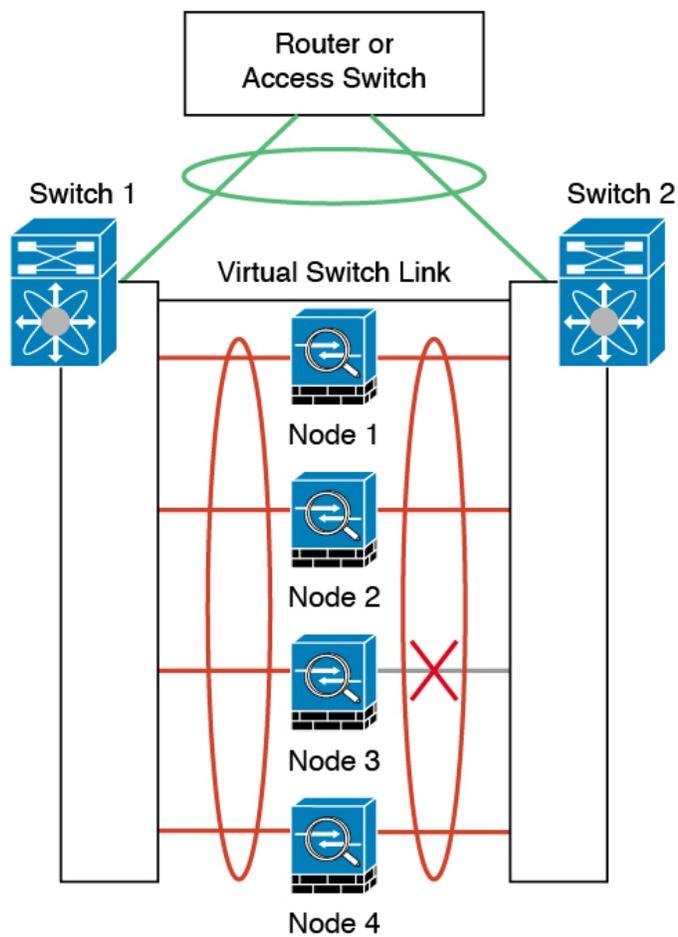
该网络中可能配置了多个 EtherChannel。下图所示为一个内部 EtherChannel 和一个外部 EtherChannel。如果 EtherChannel 中的控制链路和数据链路都发生故障，则会从集群中删除 ASA。这可以防止 ASA 在已经与内部网络断开连接的情况下收到来自外部网络的流量。
