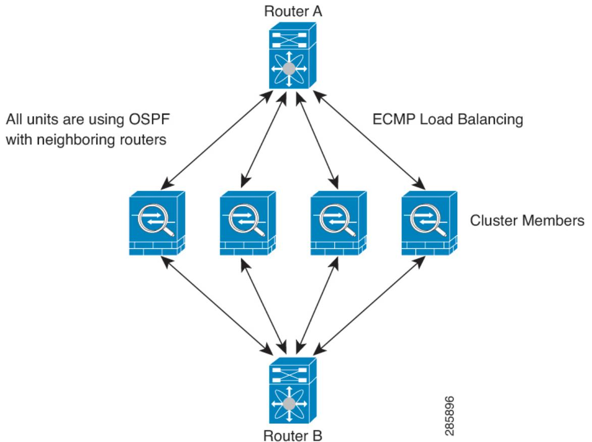
在上图中，路由器 A 获知有 4 条等价路径通往路由器 B，每条路径都要经过一台 ASA。ECMP 用于在这 4 条路径之间对流量执行负载均衡。每台 ASA 在与外部路由器通信时，会挑选不同的路由器 ID。
