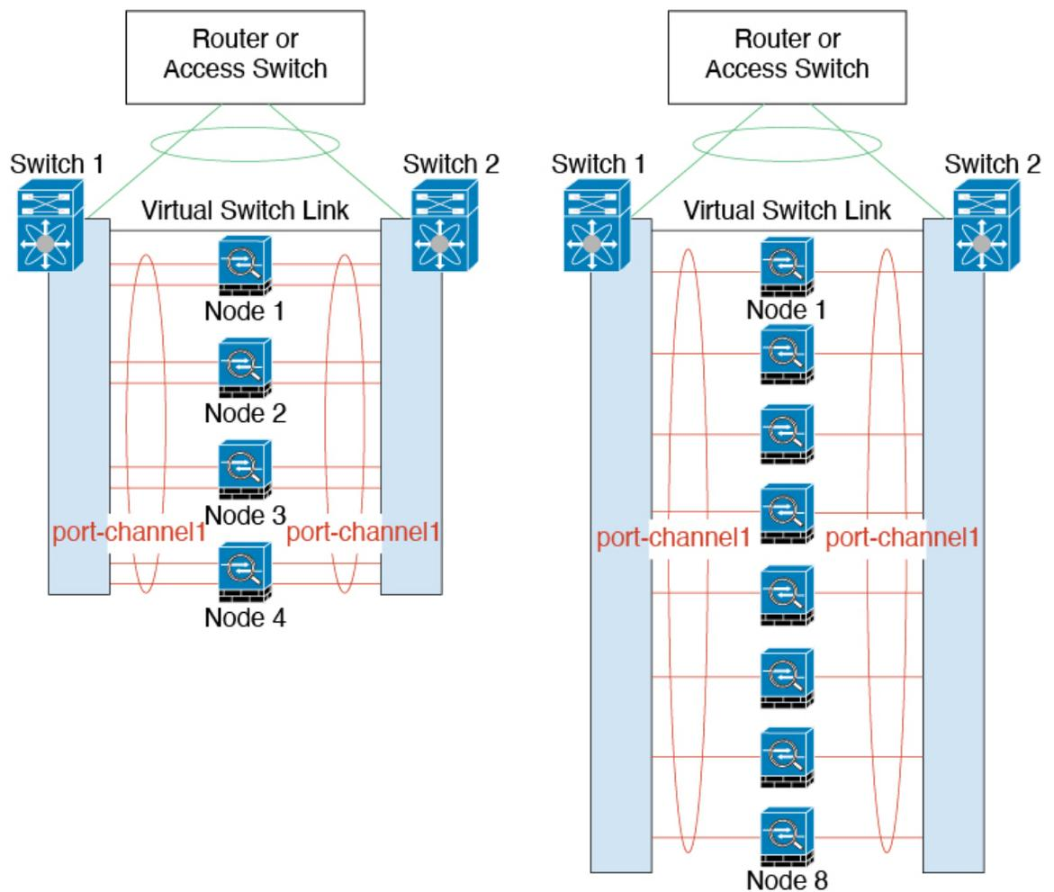
下图所示为 4-ASA 集群和 8-ASA 集群中的有 8 条活动/8 条备用链路的传统跨网络 EtherChannel。活动链路显示为实线，非活动链路显示为虚线。cLACP 负载均衡可以自动选择 8 条最佳链路作为 EtherChannel 中的活动链路。如图所示，cLACP 可以帮助实现链路级负载均衡。
