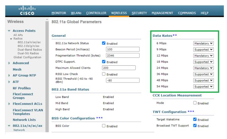
5 Ghz无线电中的默认数据速率
