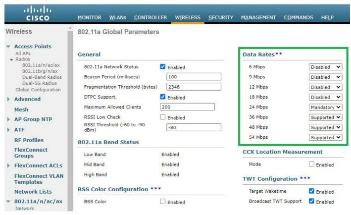
建议无线电802.11的数据速率a
