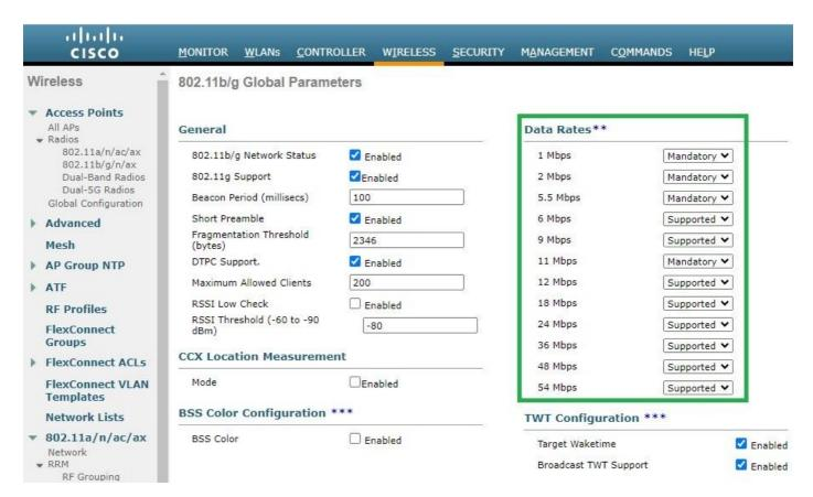
2.4 Ghz无线电中的默认数据速率
