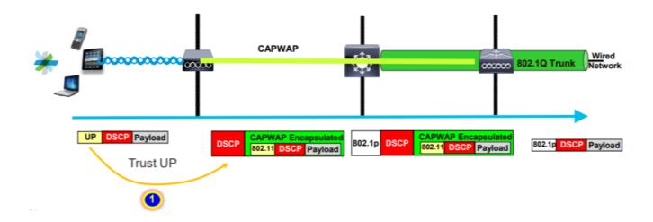
2- AP将原始数据包封装到CAPWAP报头中,并映射到UP到外部DSCP值,只要WLC上配置的QoS配置文件允许该QoS级别即可。将数据包发送到具有原始DSCP值的有线网络。
