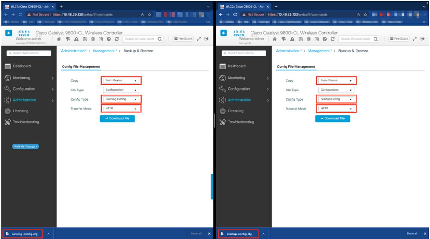
在本示例中，启动（左侧）和配置（右侧）都直接通过HTTP下载到承载浏览器访问WLC GUI的设备上。使用Transfer Mode字段，可以轻松调整要备份的文件的传输模式和目标。
