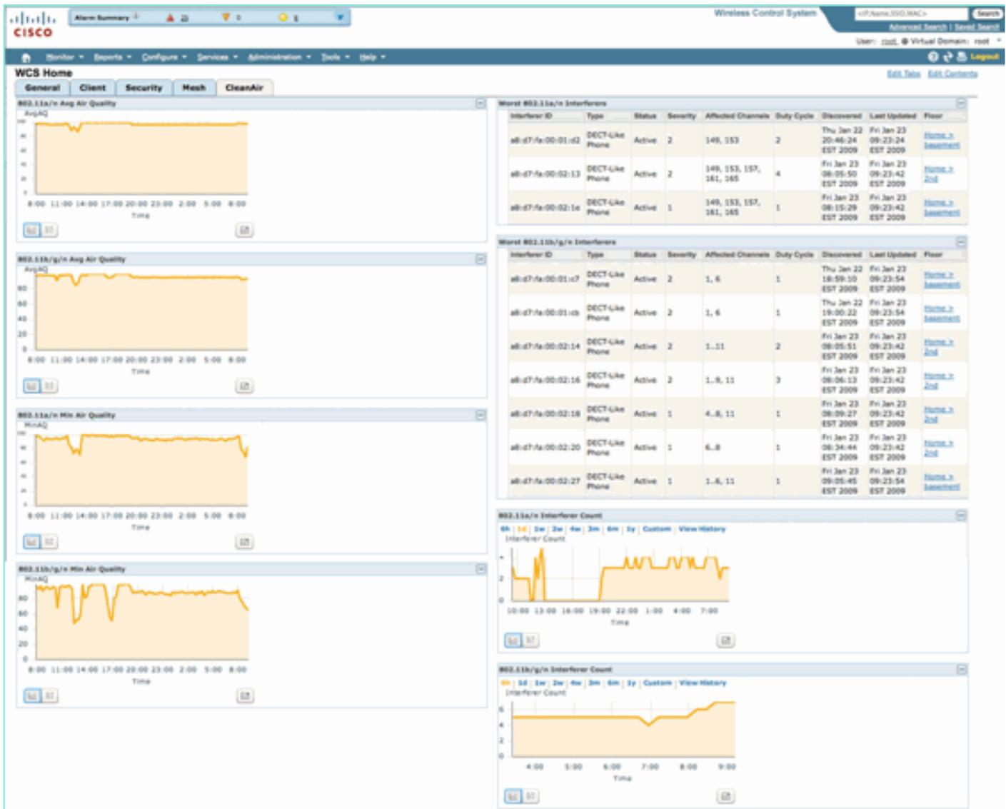
右上方的表格现在填充了每个频段检测到的10个最严重的干扰源：802.11a/n和802.11b/g/n。
