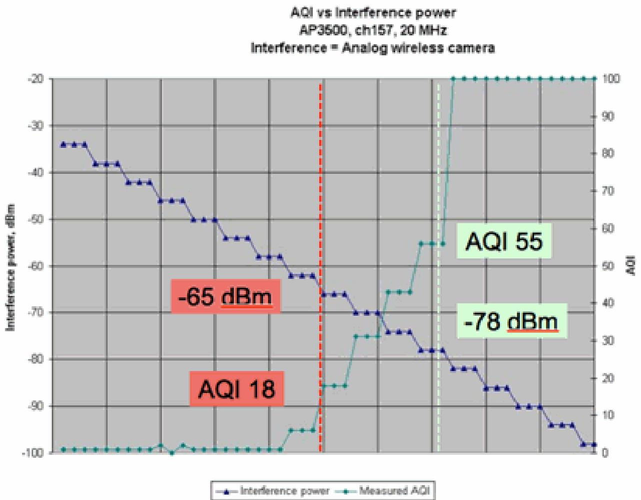
在此图的图表中可以看到，当干扰的信号功率减小时，生成的 AQI 将会增加。从技术上讲，只要信号下降到 -65dBm 以下，AP 就不会阻塞。您确实需要考虑这种情况对发射区中客户端的影响。100% 占空比 (DC) 可确保存在噪声时将持续中断 SNR 不足的客户端信号。一旦信号功率下降到 -78 dBm 以下，AQ 将快速增加。
