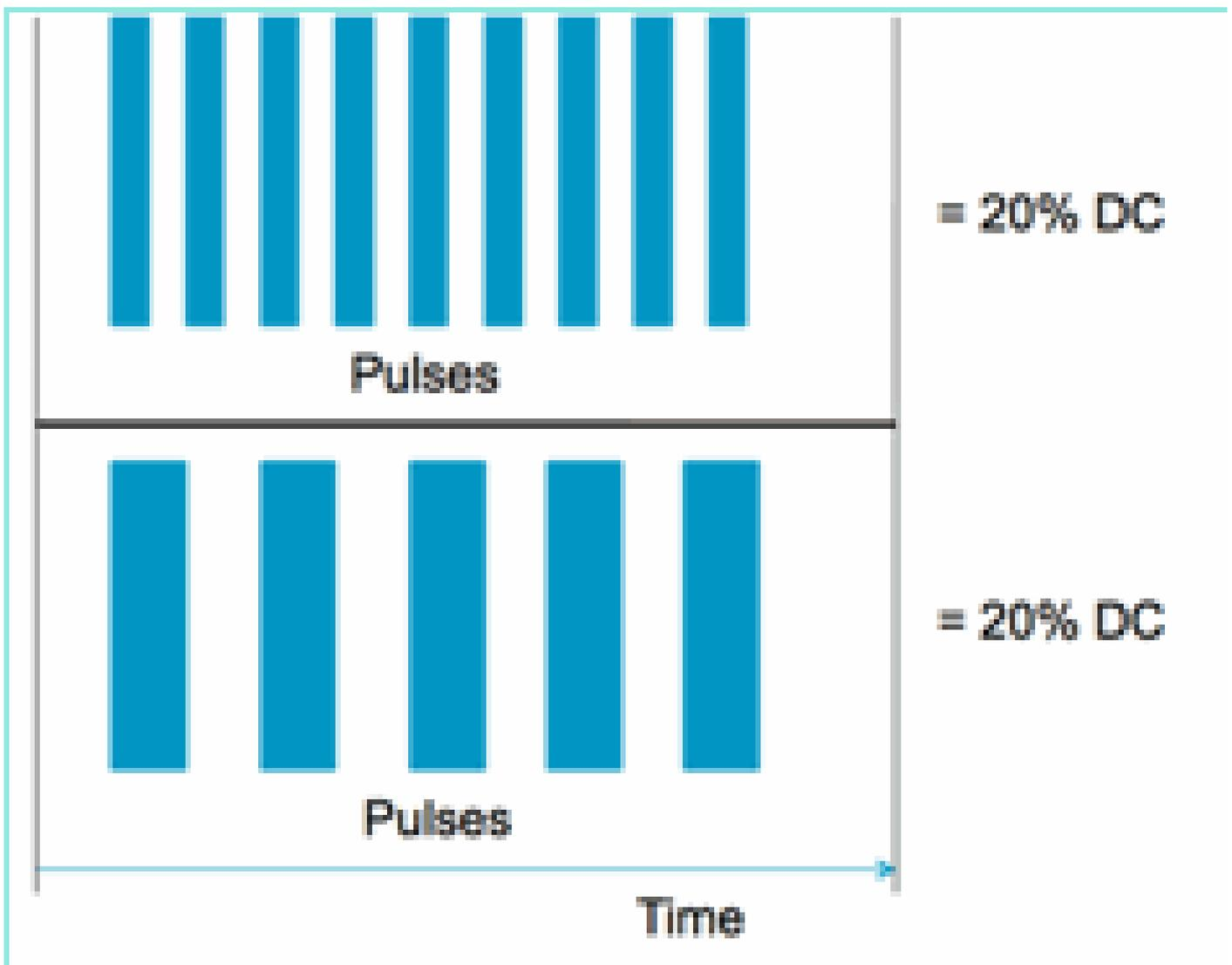
就信道和振幅中测得的占空比而言，您可能会得到两个相同的信号，但在 Wi-Fi 网络中，您会体验到两个完全不同的干扰级别。快速的重复短脉冲对 Wi-Fi 造成的破坏力，可能比相对较慢的重复宽脉冲要大。看一看 RF 干扰器吧，它会有效地关闭 Wi-Fi 信道，并且会让占空比看起来很低。
