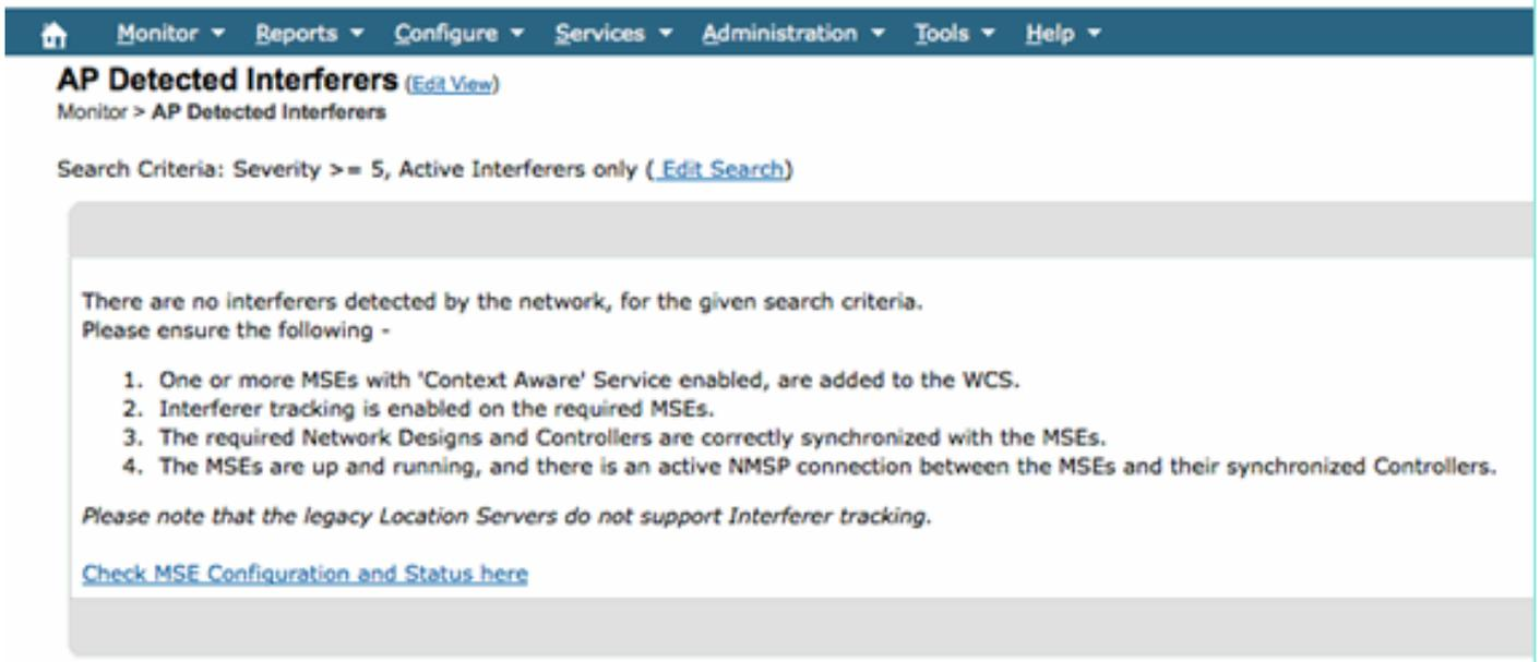
这个问题只发生在初始屏幕上，但初始化和验证新系统时，往往会忽略此问题。可以对此进行编辑以显示所有干扰源，只需将严重性值设置为 0 即可。
