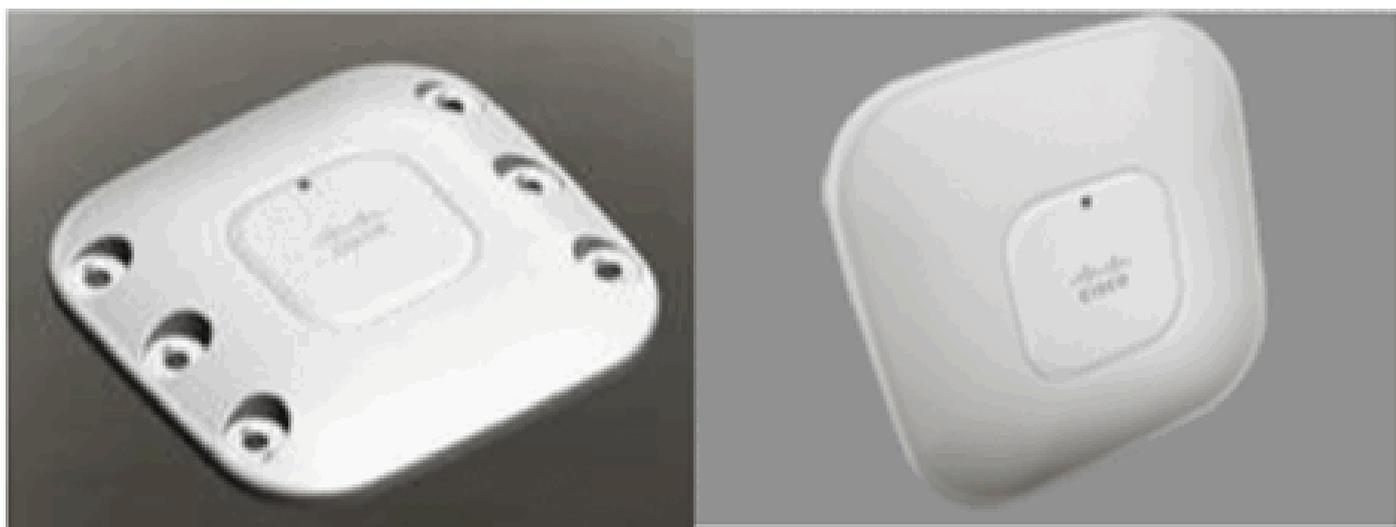
频谱分析硬件已直接集成到无线电设备的芯片组中。添置频谱分析硬件使得无线电硅片上添加了 500 K 以上的逻辑门，而且还特别提供了功能的密切耦合。通过这些无线电设备还添加或改善了其他许多传统功能。但与之相关的信息不属于本文档的范畴，因此这里未予以介绍。概言之，没有 CleanAir，单单是 3500 系列 AP 这种颇具吸引力且可靠的企业 AP 就打包了许多的功能，并体现了卓越的性能。
