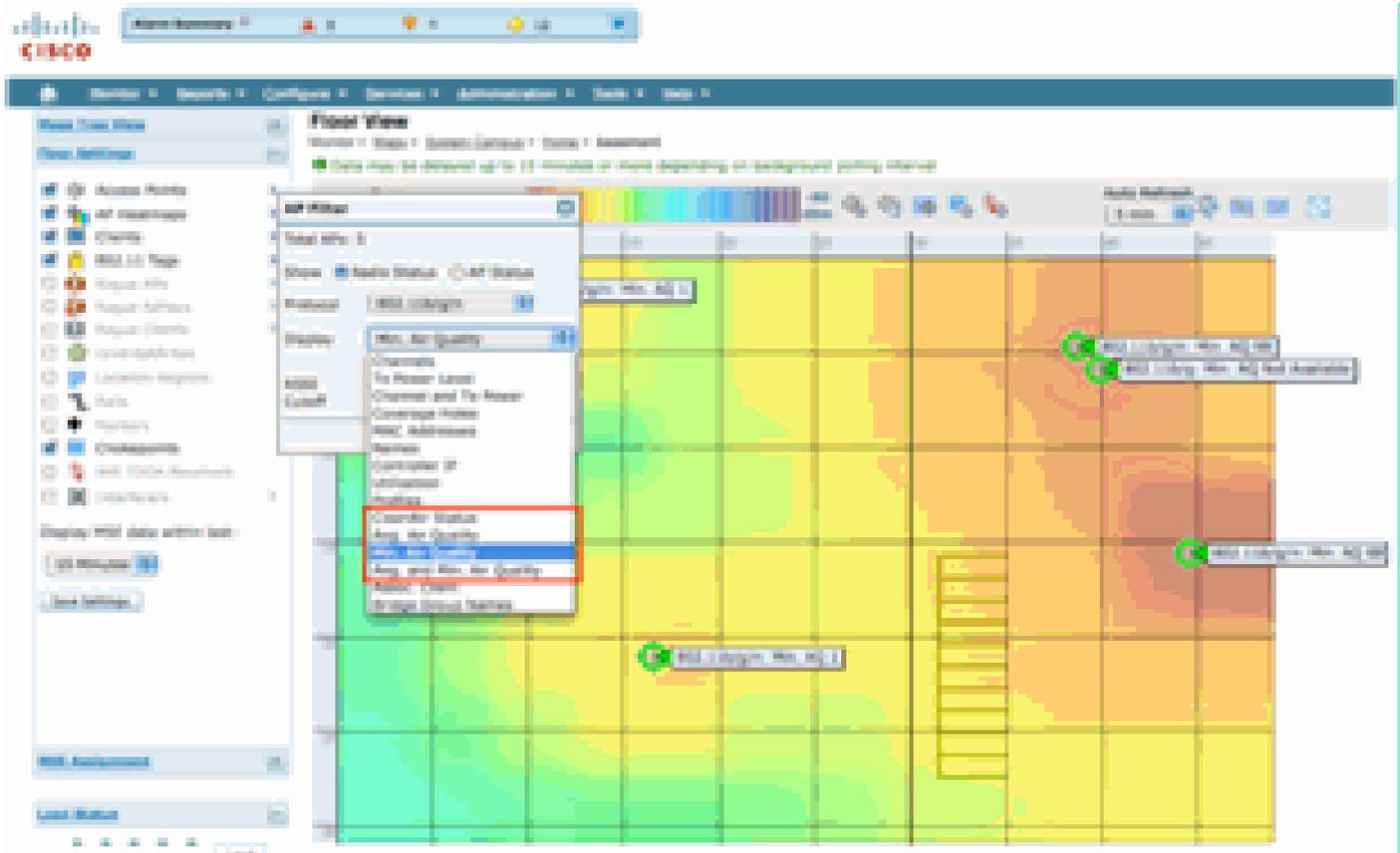
可通过多种方法查看每个 AP 报告的干扰源。将鼠标悬停在 AP 上，选择无线电，然后选择用于显示干扰源的热链接。随后将会生成在该接口上检测到的所有干扰的列表。
