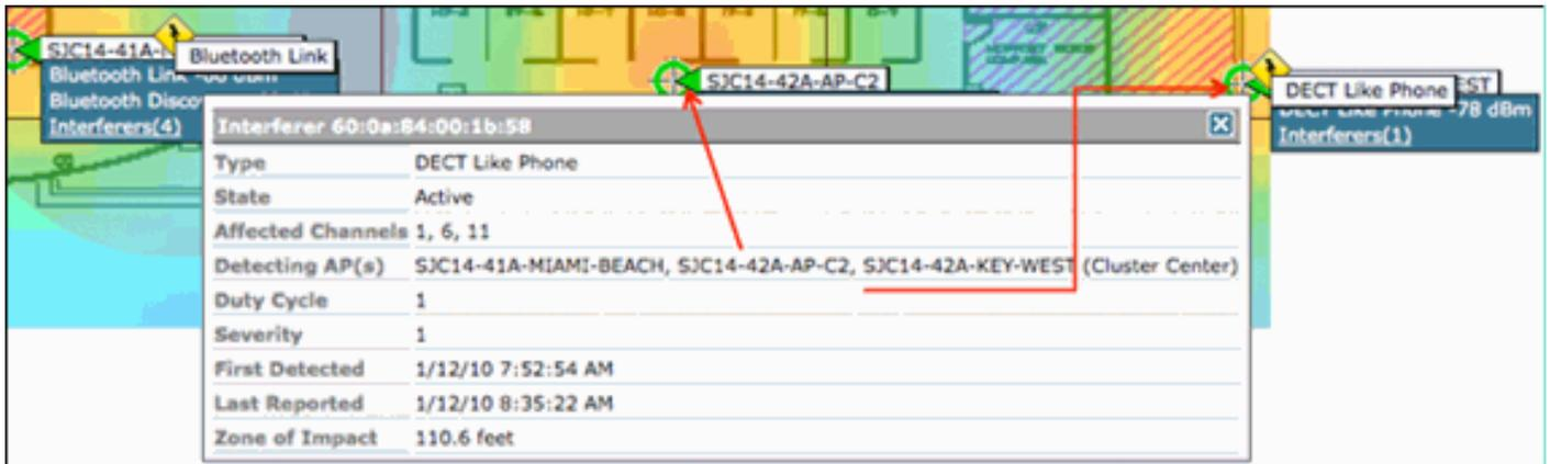
合并算法在启用了 CleanAir 的每个 WLC 上运行。WLC 针对与之物理关联的 AP 中的所有 IDR 执行合并功能。所有 IDR 以及生成的合并集群将转发到 MSE (如果系统中存在它)。包含多个 WLC 的系统需要 MSE 提供合并服务。MSE 将执行一种更高级的合并功能，该功能会设法合并从不同 WLC 报告的集群，并将要报告的确切位置信息提取到 WCS。
