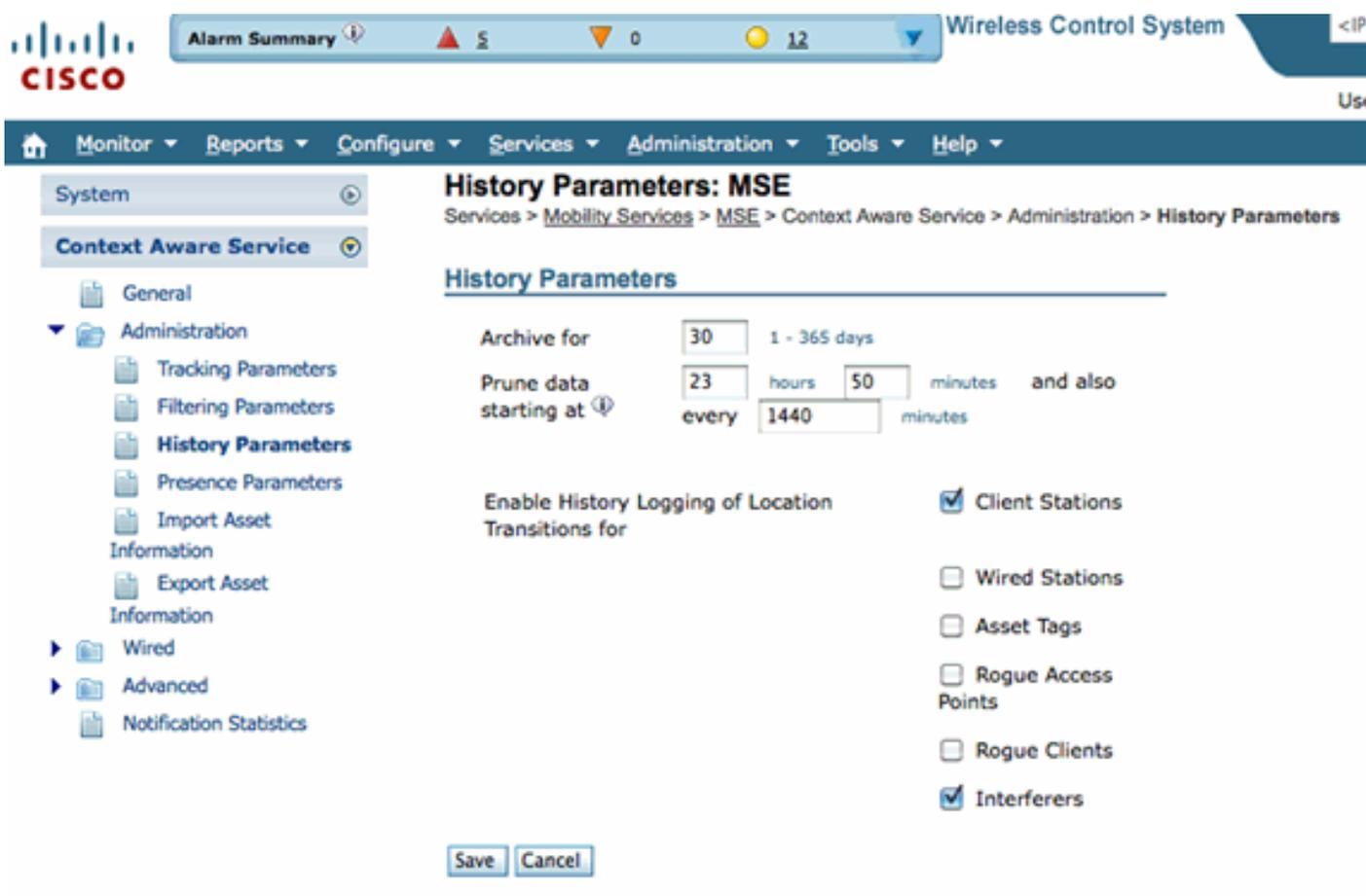
启用这些配置将会指示已同步的控制器开始将 CleanAir IDR 信息输送到 MSE，并启动 MSE 跟踪和收敛过程。从 CleanAir 的角度讲，MSE 和控制器可能会不同步。在升级控制器代码期间，如果多个控制器中干扰源的状态来回更改（干扰源被停用并重新激活），则可能会发生这种情况。只需禁
