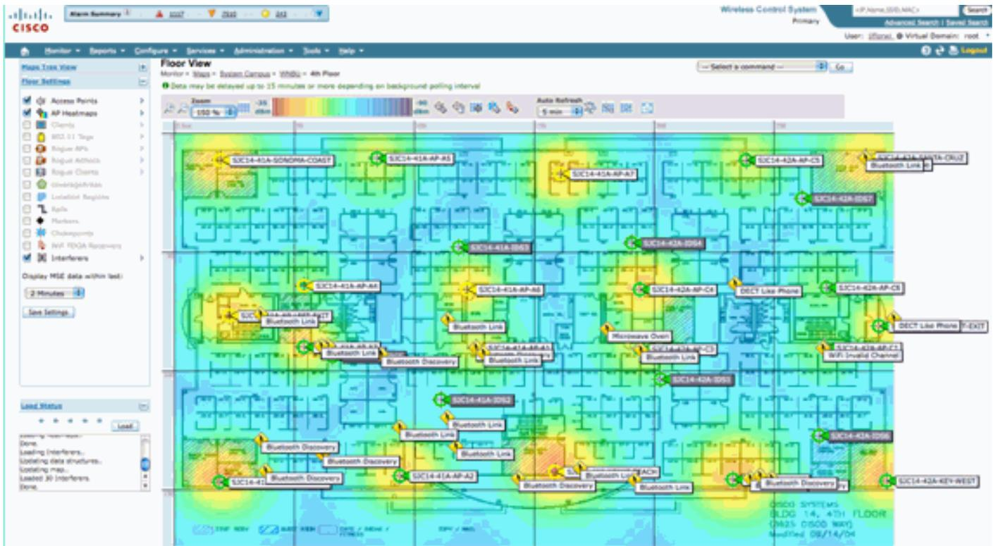
现在，在图上对干扰源进行定位可以了解它与图上其他任何元素之间的关系。要生成与设备本身相关的特定信息（请参阅图 36），请将鼠标从干扰图标上拖过。请注意执行检测功能的 AP，这是当前监听此设备的 AP 的列表。Center 集群是最接近于设备的 AP。最后一行显示影响区域。这是怀
