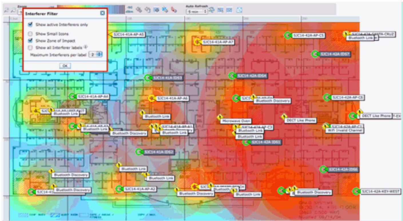
现在，可以在图上看到影响区域 (ZOI)。ZOI 是作为围绕所检测到设备的圆圈呈现的；严重性越高，圆圈的不透明暗度就越高。这非常有助于形象地显示干扰设备的影响。小黑圆圈比半透明的大圆圈更应该受到重视。您可以将这些信息与您选择的其他任何图屏幕或元素结合起来。
