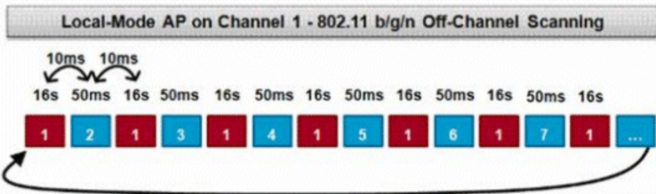
此图描述了2.4GHz频段中本地模式AP的信道外扫描算法。如果AP有一个类似操作，则在5GHz无线电上并行执行操作。每个红色方块代表在AP主信道上花费的时间，而每个蓝色方块代表在相邻信道上花费的时间。
