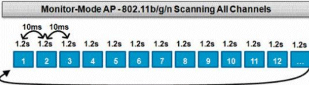
此图描述了2.4GHz频段中监控模式AP的信道外扫描算法。如果AP有一个类似操作，则在5GHz无线电上并行执行操作。
