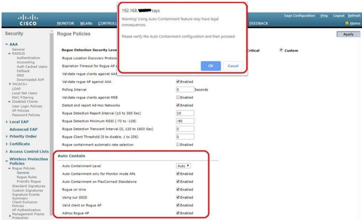
单击Apply将数据发送到Cisco WLC，但不会在整个电源周期中保留数据；这些参数临时存储在易失性RAM中。
