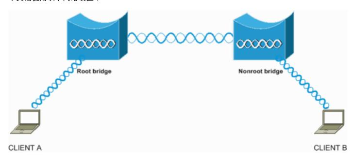
此设置使用两Aironet 1300系列无线网桥。其中一个网桥为根网桥模式被配置,并且另一个网桥为无根的网桥模式被配置。客户端A与根网桥产生关联,并且客户端B与无根的网桥产生关联。因为网络图显示,所有设备在范围10.0.0.0/24使用IP地址。此配置建立网桥之间的点到点无线连接。在无线网桥能连通前,他们必须彼此验证。网桥使用任何一个这些认证方法:
