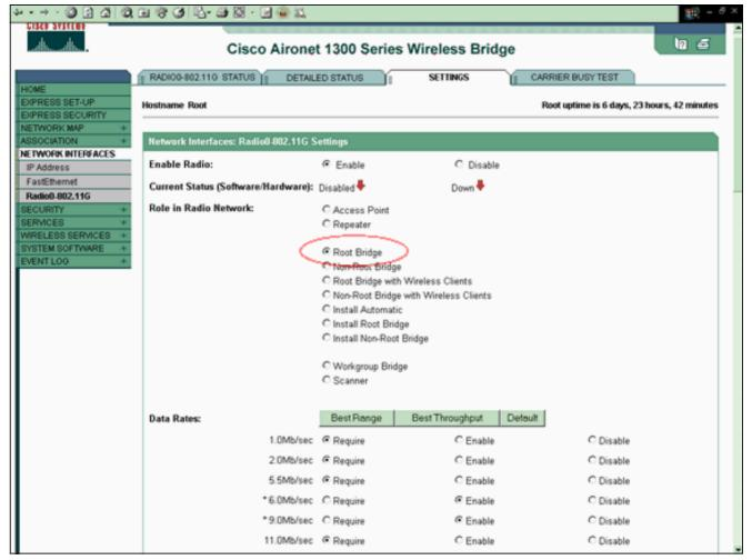
Note: 如果使用IEEE 802.11b标准的网桥或有802.11b客户端用1300无线网桥,请保证您不选择为正交频分复用技术(OFDM)数据速率要求。如果选择为这些数据速率请要求,设备不联合。设备不联合,因为802.11b设备不支持运行基于IEEE 802.11g标准的OFDM费率。在网络接口:Radio0-802.11G Settings窗口示例,OFDM数据速率显现在费率旁边的星号(\*)。在本例中的设置也显示您您如何必须配置在802.11g环境里运行的802.11b设备的数据速率。输入1距离(Km)参数的,留下所有其他参数在他们的默认值,并且点击适用在窗口的底部。
