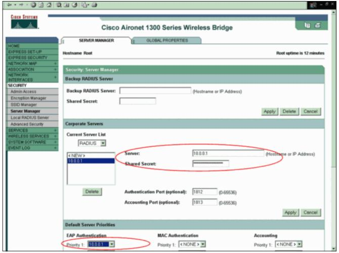
Note: 本地RADIUS服务器在端口1812和1813监听。在此窗口中默认服务器优先范围,请选择本地RADIUS服务器IP地址并且点击**适用**。为了enable (event) WEP加密,完成这些步骤:Note: LEAP认证要求WEP加密被启用。选择 Security > Encryption Manager。在加密模式地区中,请选择必需对于WEP加密并且从在密码旁边的下拉菜单选择WEP128位。在加密密钥地区中,请选择128位作为密钥大小并且输入加密密钥。Note: 此加密密钥必须匹配您在无根的网桥配置的加密密钥。在本例中,加密密钥是1234567890abcdef1234567890。示例如下
