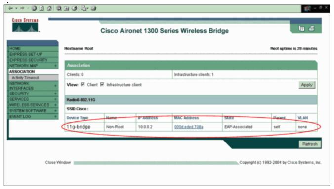
3. 验证在无根的网桥关联表的连接。
