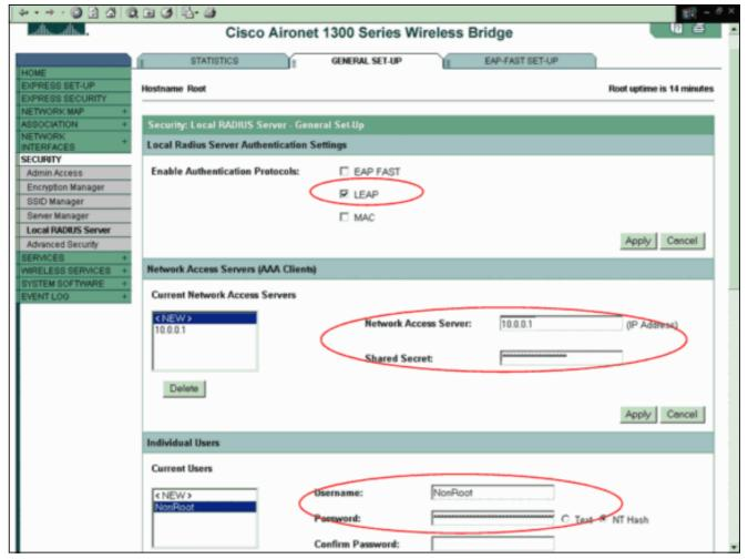
在个人用户地区中,请定义个人用户并且点击**适用**。您配置的用户名和密码必须匹配LEAP客户端的用户名和密码。在本例中,这些字段必须匹配无根的网桥的用户名和密码。用户名字是无根的,并且密码是Cisco123。Note: 组是可选的。组属性不通过对激活目录并且是只本地相关的。您能添加后组,在您确认后基本配置正确地工作。
