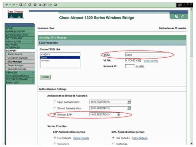
Note: 在Cisco IOS Software Release 12.3(4)JA和以后,您配置Ssid全局然后适用他们于一个特定无线接口。请参见<u>创建配置多个SSID的</u>本文的*SSID全局*部分为了配置Ssid全局。并且,在Cisco IOS Software Release 12.3(7)JA,没有默认SSID。移下来到全局Radio0-802.11G属性地区并且完成这些步骤
