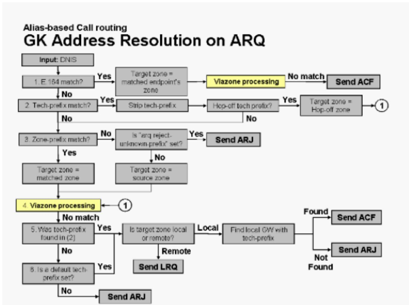
语音基础设施和应用 (VIA) 功能是现有 Cisco 网守镜像的软件增强功能。通过此增强功能，Cisco 网守可以识别同一平台 (IP 到 IP 网关) 上的二个呼叫段，也可以对多个 IP 到 IP 网关间的流量进行负载平衡，这些网关 (网关和网守) 包含在预定义的 VIA 区域中。这些网守位于 Internet 电话服务提供商 (ITSP) 网络的边缘，类似于 VoIP 中转点或传输区域，VoIP 流量将在到达远程区域目标的过程中通过该中转点或传输区域加入信道。VIA 区域中的 IP 到 IP 网关可终止传入呼叫，然后朝其最终目标重新发起这些呼叫。有关 VIA 区域的详细信息，请参阅[使用 Cisco 多服务 IP 到 IP 网关功能的远程到本地网络](#)。
