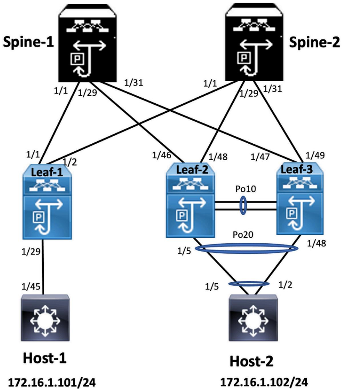
在图中，主机连接到一对具有 vPC 域 ID 的 Nexus 9000 交换机，但主机配置的交换机本身不运行 vPC。接入交换机/主机在不了解 vPC 的情况下将上行链路注册为简单端口通道。
