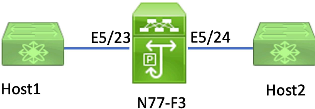
在本文中，连接到N77-F3端口E5/23的Host1将流量发送到Host2。ELAM用于捕获从主机1到Host2的单个帧。
