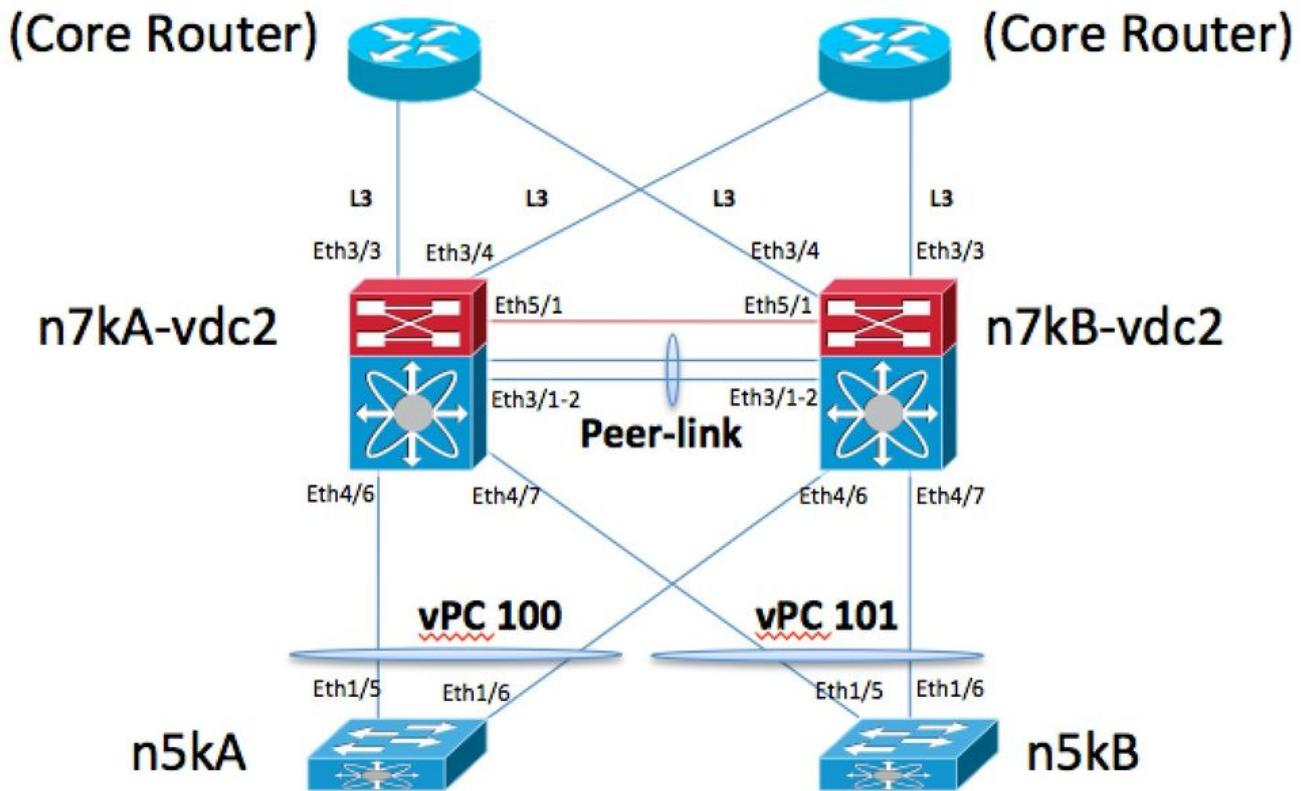
vPC对等链路是端口通道1。Ethernet 5/1是vPC对等保持连接链路。每个N7K机箱上有两个核心路由器，它们通过L3/30链路e3/3和e3/4连接。N5KA和N5KB模拟连接在vPC 100和vPC 101上的第2层交换机vPC。N7KA是vPC主设备。
