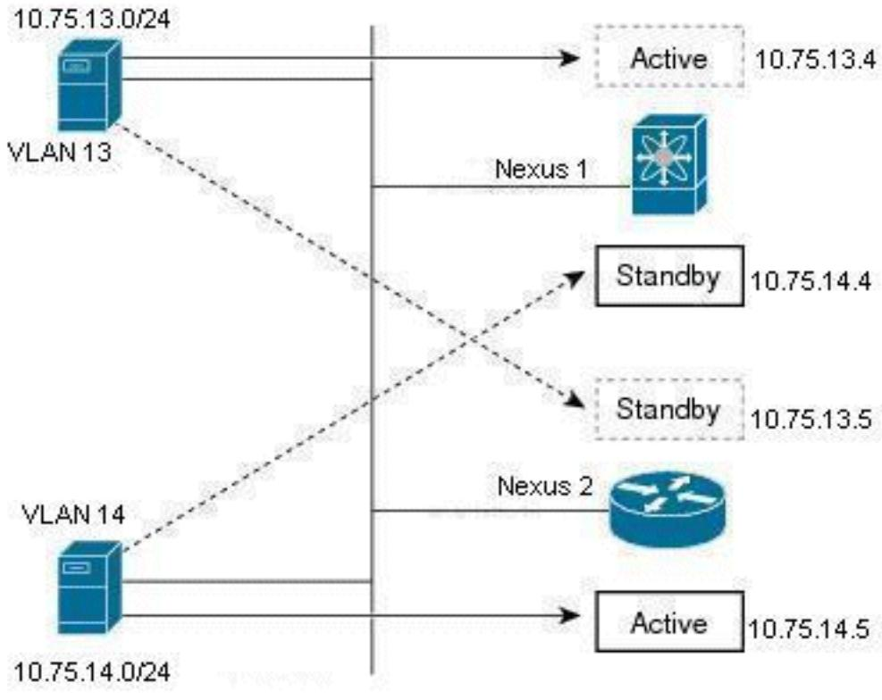
这是HSRP的示例，其中有两台路由器（Nexus 1和Nexus 2）和两个组用户（VLAN 13和VLAN 14）。通过下面给出的配置，Nexus 1是VLAN 13中用户的活动路由器和VLAN 14中用户的备用路由器；Nexus 2是VLAN 14中用户的活动路由器，VLAN 13中用户的备用路由器。因此，流量将由这两台Nexus路由器共享，并提供第一跳路由冗余。
