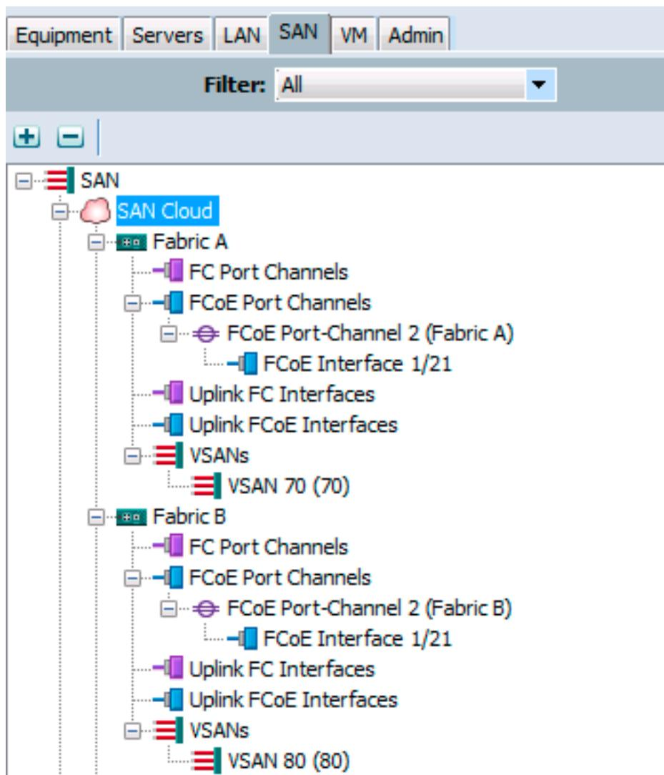
上一个示例显示了UCS的视角。交换矩阵的每一端都有一个端口通道，2号基于端口ethernet1/21。
