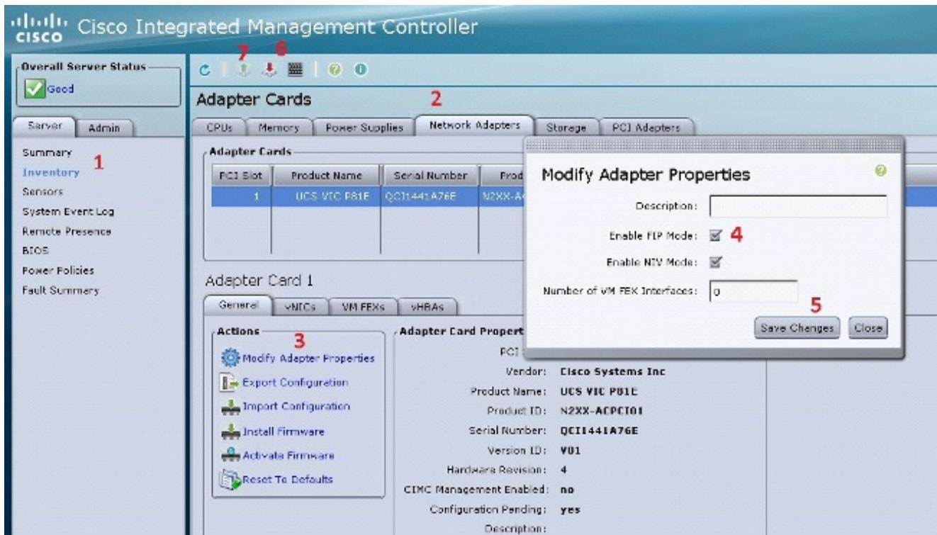
6. 在服务器启动后，选择Inventory > Network Adapters > vNICs > Add 以创建vNIC。要定义的最重要字段包括：要使用的VIC上行链路端口（P81E有2个上行链路端口，被引用为0和1）。通道号—适配器上vNIC的唯一通道ID。这在Nexus 5000上虚拟以太网接口下的bind命令中引用。信道号的范围仅限于VNTag物理链路。该通道可视为交换机和服务器适配器之间物理链路上的“虚拟链路”。端口配置文件—可以选择上游Nexus 5000上定义的端口配置文件列表。如果Nexus 5000配置了vethernet auto-create命令，则Nexus 5000上将自动创建虚拟以太网接口。请注意，只有虚拟以太网端口配置文件名称（端口配置文件配置不是）才会传递到服务器。在建立VNTag链路连接并在交换机和服务器适配器之间执行初始握手和协商步骤后，会发生这种情况。
