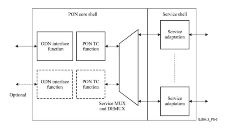
功能块类似于 OLT。在ONU/OLT使用单个PON接口(出于保护目的最多2个)操作的场景中,省略交叉连接功能。服务 MUX 和 DEMUX 将负责流量,而不是此功能。
