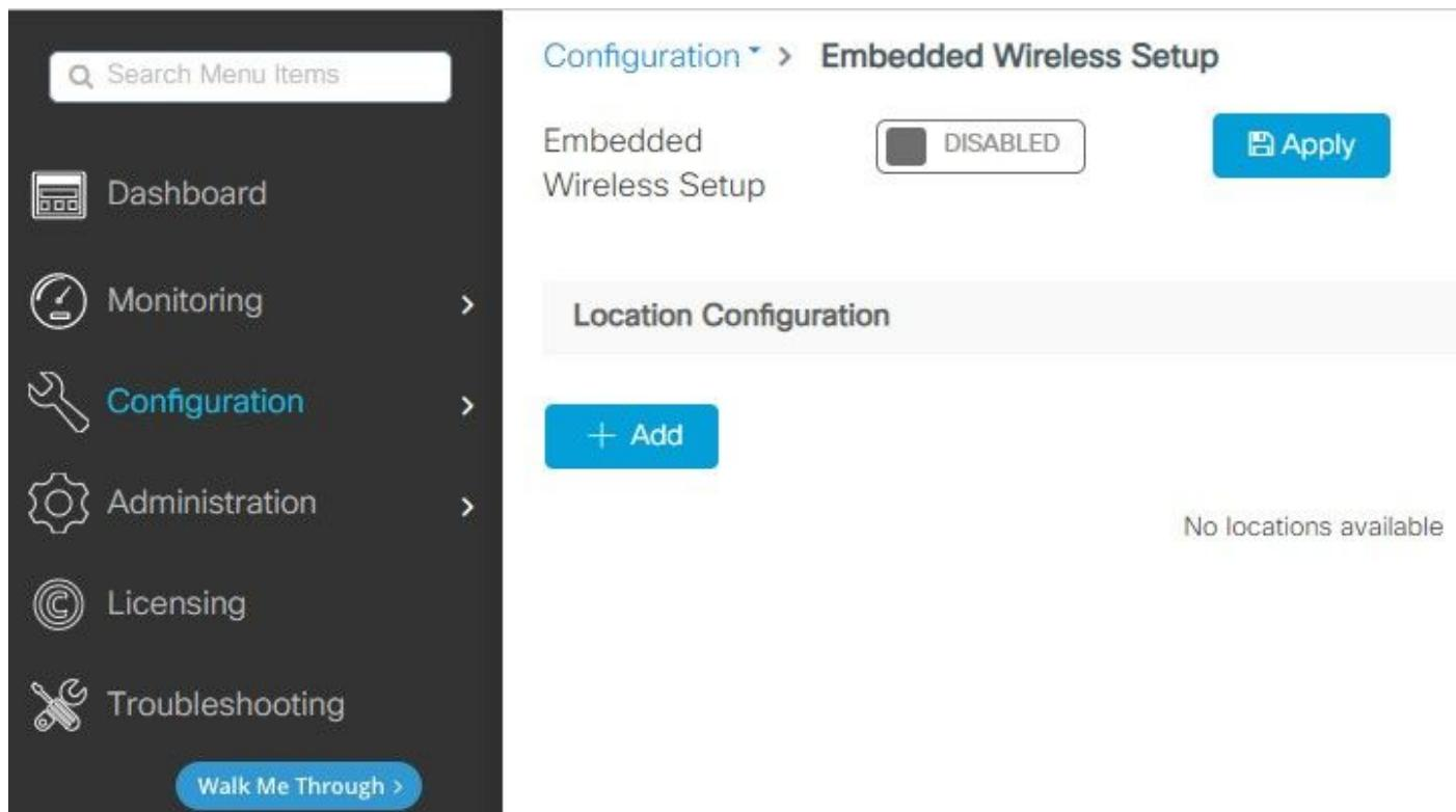
启用嵌入式无线设置后，这些命令会被推送到CLI。这些CLI在Catalyst 9K交换机上启用lisp交换矩阵，因此它将用作控制平面/映射服务器节点、具有环回作为WMI的无线控制器以及到控制平面映射的WLC，以允许AP和客户端入网。
