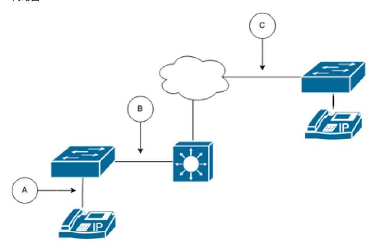
在路径中选择一个捕获点。它可以是A(最接近一个IP电话)、B(路由前)、C(最接近目标)。
