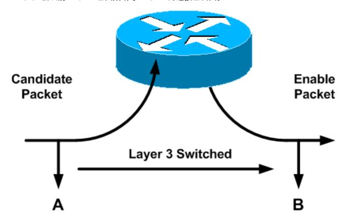
此图说明了创建快捷方式必须完成的三个基本要素(使用MLSP):候选、启用和缓存步骤。MLS-SE检查缓存MLS条目。如果MLS缓存条目和数据包信息匹配("命中"),则数据包报头重写在交换机本地进行。此重写是路由器的快捷方式或旁路。数据包不会像通常那样转发到路由器。不匹配的数据包作为候选数据包转发到MLS-RP。这些数据包可能会发生本地交换机。在候选数据包通过MLS流掩码(IP MLS技术故障排除部分的步骤7解释了该步骤)和重写数据包报头中的信息(不与数据部分联系)后,路由器沿目的路径将数据包发送到下一跳。该数据包现在是启用码包。如果数据包返回到数据包离开的同一MLS-SE,则会创建MLS快捷方式并将其放入MLS缓存。现在,交换机硬件在本地重写该数据包以及随后的所有类似数据包("流"),而不是路由器软件。
