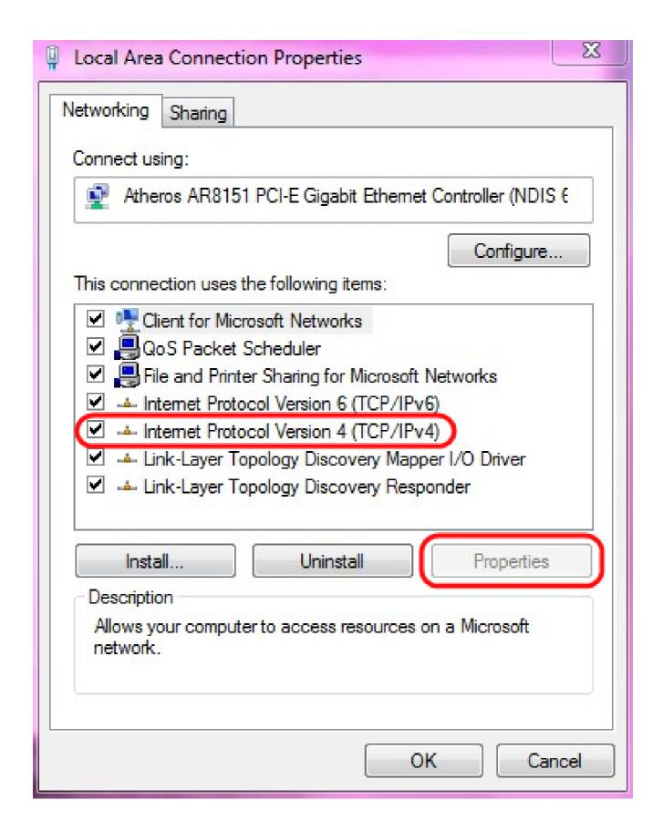
步骤 14选择Internet Protocol Version 4(TCP/IPv4),然后单击Properties打开Internet Protocol Version 4(TCP/IPv4)Properties窗口。
