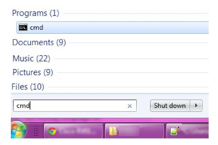
步骤 10键入命令ipconfig并按Enter。在Ethernet Adapter Local Area Connection区域下,检查IP地址和子网掩码是否与路由器配置匹配。如果IP地址匹配,请跳至步骤20。
