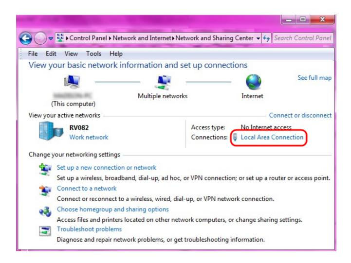
步骤 12找到RV042/RV082提供的网络。单击RV042/RV082网络右侧的本地连接。出现Local Area Connection Status窗口。
