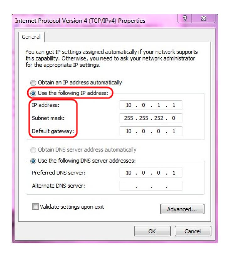
步骤 15单击Use the following IP address单选按钮,您现在可以配置该LAN连接的IP地址、子网掩码和默认网关。
