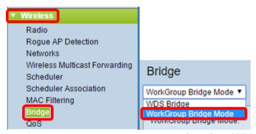
步骤2.选中Enable WorkGroup Bridge Mode(启用工作组网桥模式)复选框。
