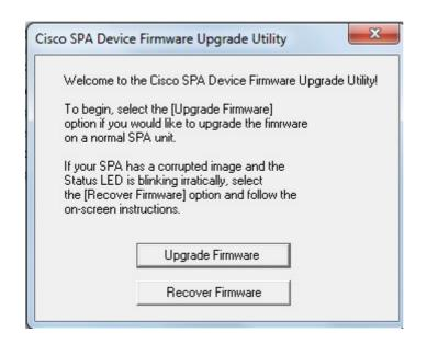
步骤8.单击Upgrade Firmware按钮以启动固件升级过程。
