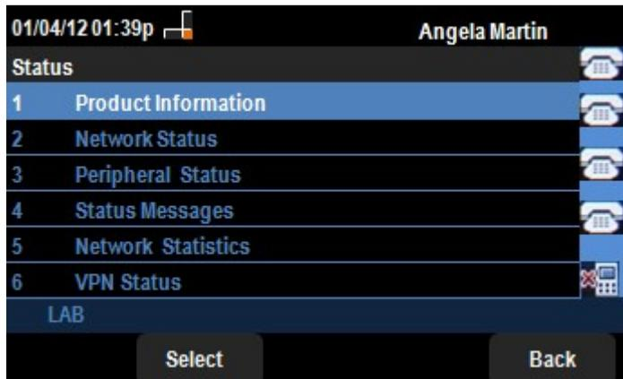
步骤3.使用导航键，向下滚动到上一步中输入的“状态”菜单中的“状态”消息。按选择软键。系统将显示“状态消息”菜单。
