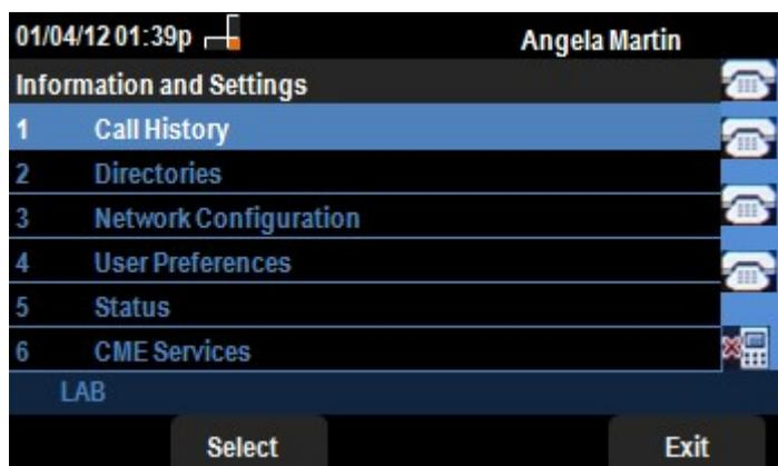
步骤2.使用导航键并向下滚动到Status。按选择软键。系统将显示“状态”菜单。
