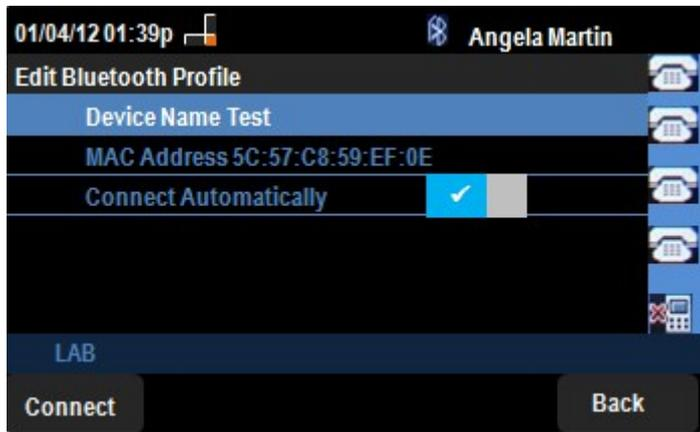
步骤5.最终设置显示在“编辑蓝牙配置文件”列表中。按连接软键。检查手机。
