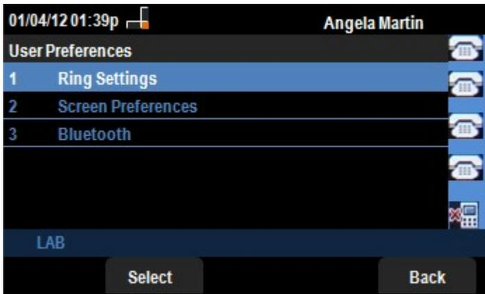
步骤3.使用导航键并向下滚动到蓝牙。按选择软键。出现“Bluetooth Configuration(蓝牙配置)”菜单。确保已启用蓝牙。
