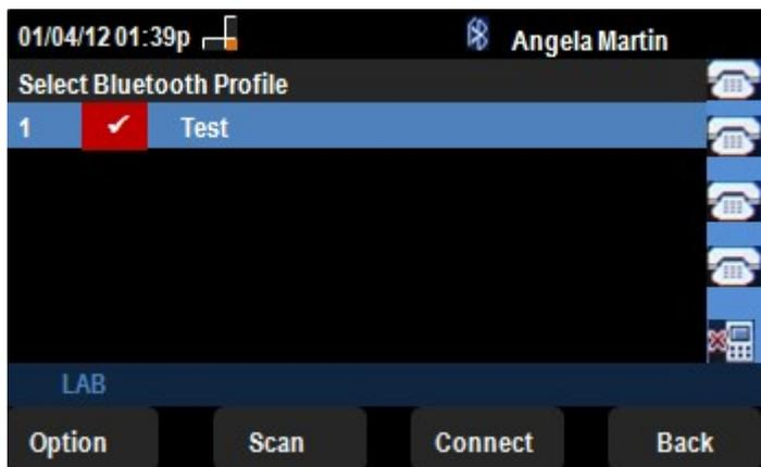
步骤6.在手机上弹出连接请求，要求输入PIN。默认PIN为“0000”。输入PIN并允许SPA525G/SPA525G2与手机连接。连接后的手机将显示在SPA525G/SPA525G2的“选择蓝牙配置文件”列表中。
