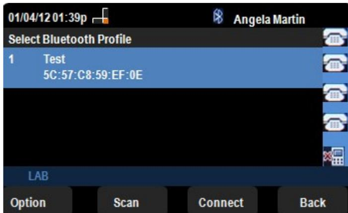
步骤5.按“扫描”软键扫描手机。活动的手机将显示在“选择蓝牙设备对”列表中。选择适当的手机，然后按连接软键继续。
